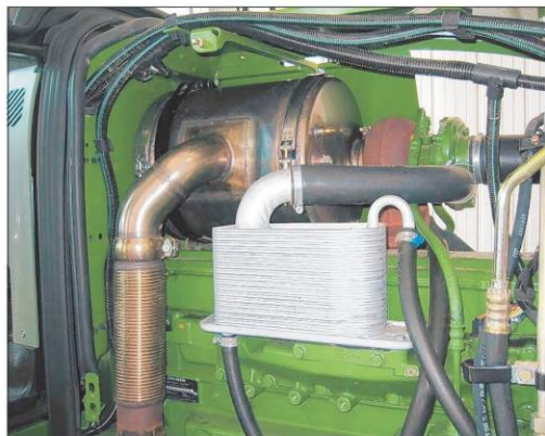
Der Osterrönfelder Betrieb rüstet auch Tractor mit selbst hergestellten Tuning-Kits und Rußfiltersystemen aus. Eine Rußpartikel-Reduzierung von über 99,3 Prozent wird damit erreicht.
