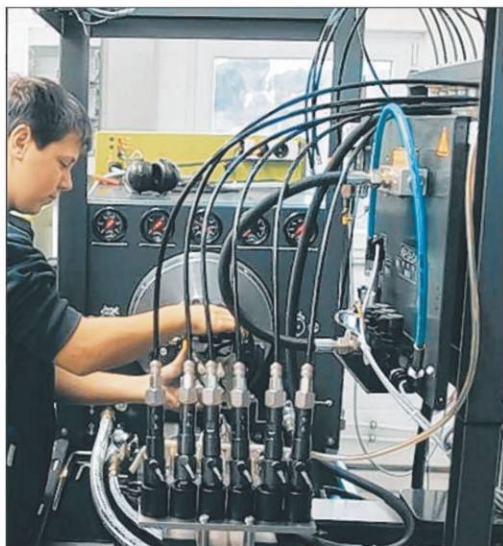
Zu einer modern eingerichteten Dieselmotoren-Werkstatt gehört auch ein Pumpen-Prüfstand für Einspritzdrücke von bis zu 1600 bar für die neueste Common-Rail-Generation.
