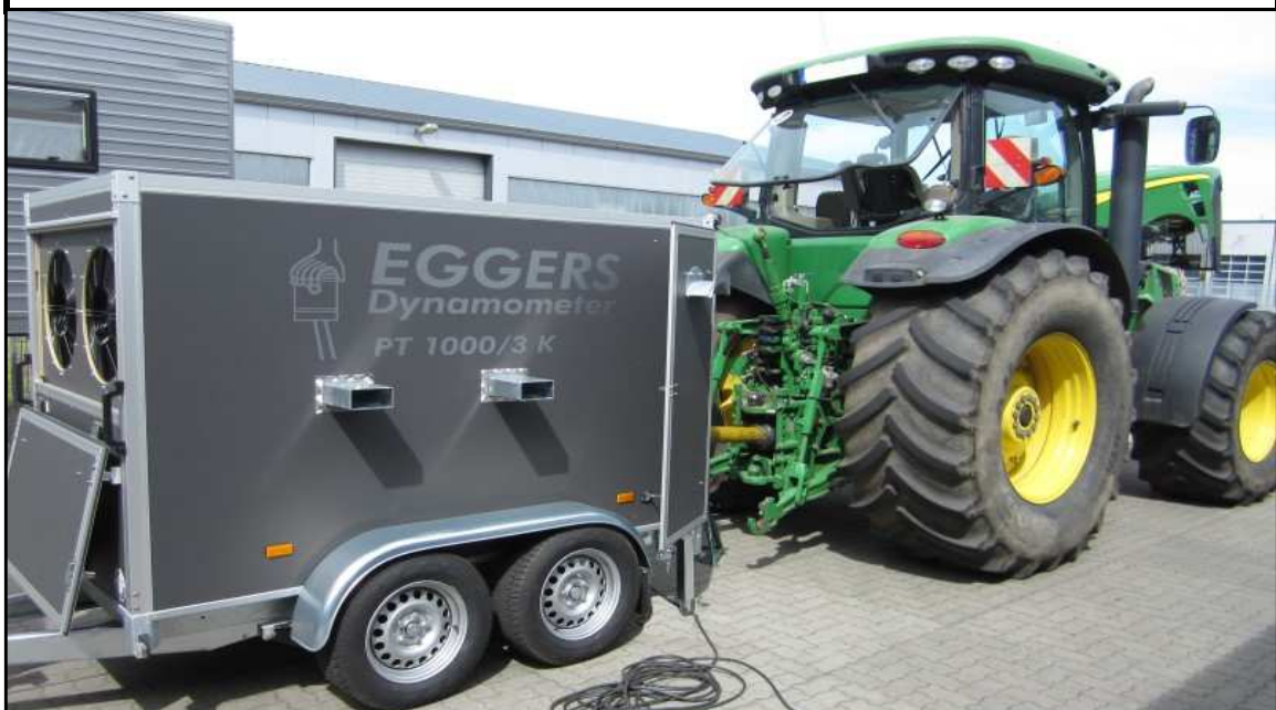
Leistungsmessung bei einem Schlepper
