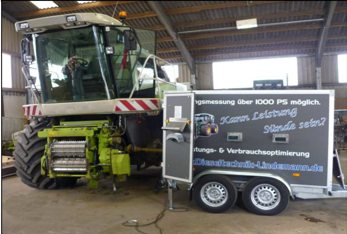
Leistungsmessung bei einem Feldhäcksler
